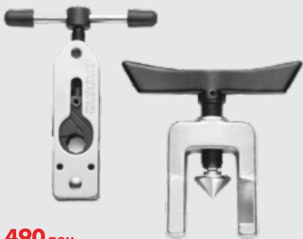
2.490 ден. АЛАТ ЗА ПРОШИРУВАЊЕ НА ЦЕВКИ 3/16 - 5/8 инчи, 5 - 16 мм 0715 43 022 За создавање отвори од 45° на цевки од бакар, месинг, алуминиум и мек челик.
