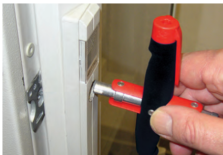
Двоен крај за смена на заклучвачки механизам.
