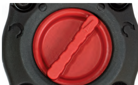
Преклопник за менување на насоката и моментот на затегнување
