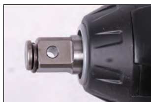
Отвор со четириаголен прифат за пин за заклучување на насадниот клуч
