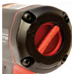
Преклопник за менување на насоката и моментот на затегнување
