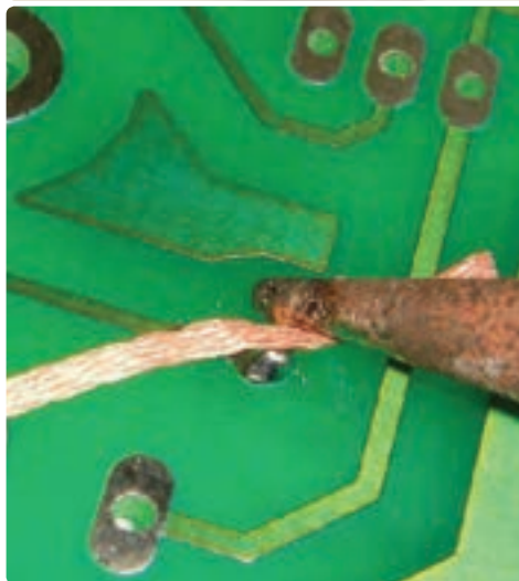
Одстранување на вишокот на лем, потпомогнато со жица за одлемување
