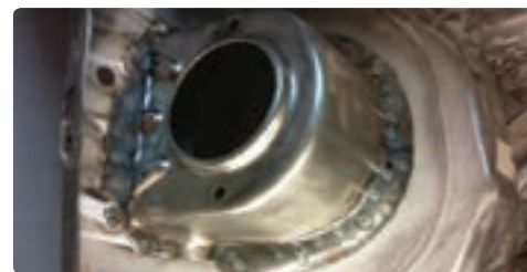
Точкасто заварување на седиштето на амортизерот
