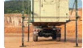
Конструкција за мирување на надоградби
