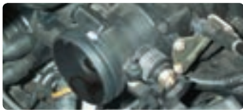
Пригушен вентил на усис
