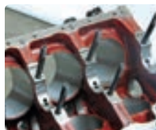
"Brezon" на блокот на моторот
