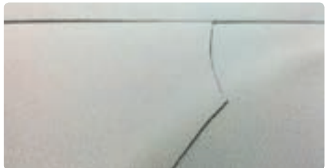
Пукнатини на инструмент таблата
