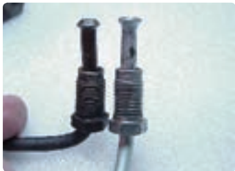
Навојни оштетувања и нови спојници на кочните водови
