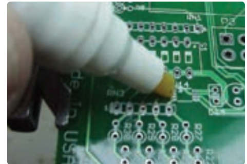
Контролирано нанесување на топители со молив
