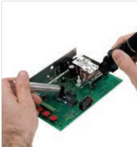
Лемење на печатени плочи со контролиран пламен
