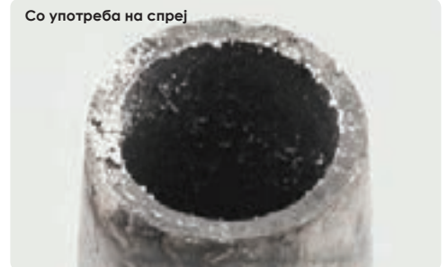
Млазница на горилник после еден саат работа
