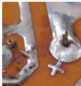
Откривање на ладниот лем на печатените плочки
