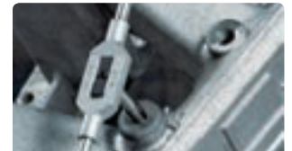
Врежување навои во епоксиден стик метал
