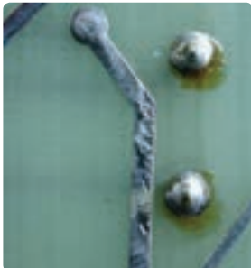
Откривање на ладниот лем на релени
