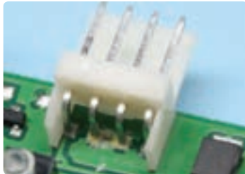
Остатоци од колофониумот на контактните приклучоци
