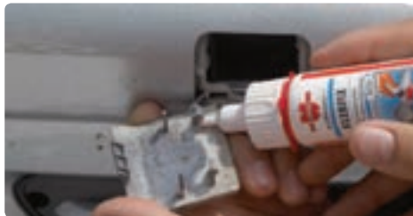
Лепење на метал и пластика
