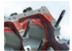
"Brezon" на блокот на моторот
