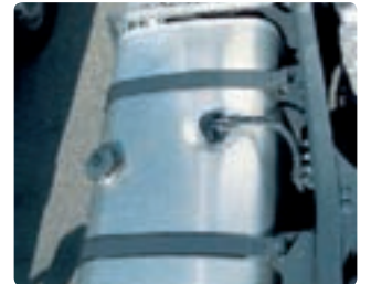
Корозија на резервоарот за гориво
