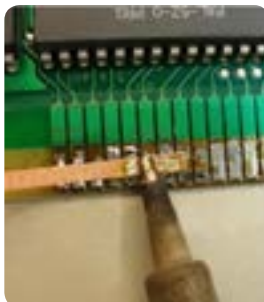
Отстранување на вишок лем со помош на жица за одлемување
