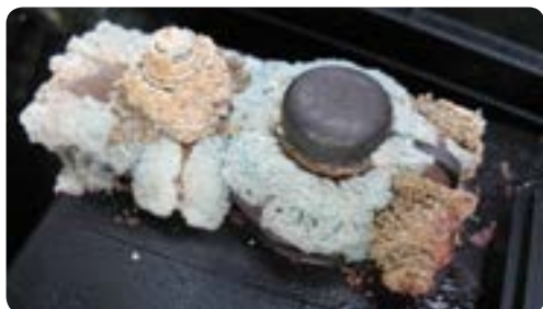
Потполна оксидација на акумулаторски полови
