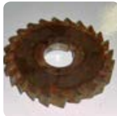
Корозија на сечива на фрези, стругарски ножеви, пили и сл.
