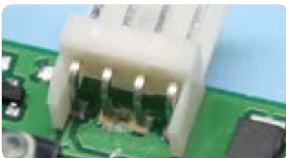
Остатоци од колофониум на контакти на приклучок
