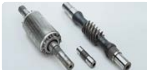
Истрошени осовини репарирани и обработени со стругање
