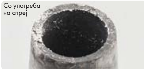
Млазница на горилник по еден час работа
