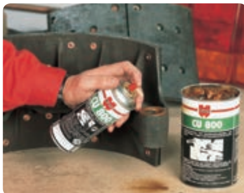
Превентивното подмачкување при монтажа спречува заридување и појава на корозија
