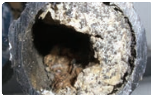
Попречен пресек на затнат одвод
