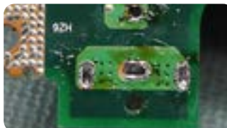
Оксидираност на неисчистено место на лемење
