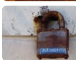
Силна длабинска корозија
